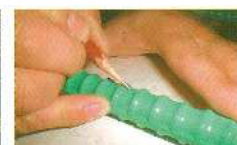
塗膜硬化性試験
