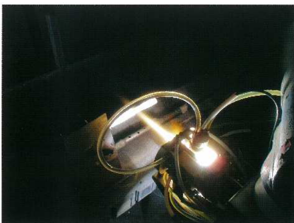
プラズマ溶射によるセラミックコーティング
